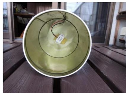
これまたこわれたプラスチック板に穴を開けて、銅線や被覆をむいた線を通してセンサーを作ってみた。線間のギャップで水滴を捕らえなければ
