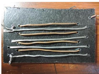
ならないので、出来るだけ狭い間隔で配線しなければならいのだが、手作業には限界がある。出来上がったのは、60mm×35mm のプラスチック板に並べた 8 本の裸線。(これを「センサー Rev.A」と名付けた:左画像)
